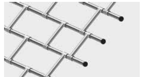
MIT STEGTEILEN VERBUNDENE GERADE STAHLROHRE Lochgröße 250 - 380 x 100 mm, Luftdurchlässigkeit ~ 80%
