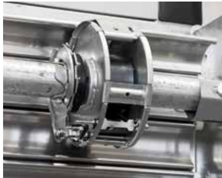
SICHERUNG beim Federbruch
